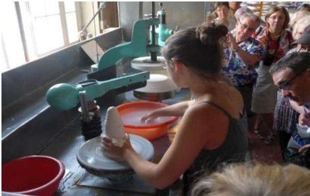
Atelier de tournage et de calibrage, fabrication d'une assiette.
