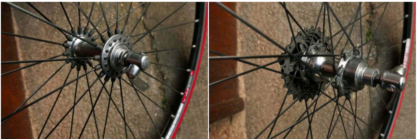
Détails des moyeux avec les pions amortisseurs
